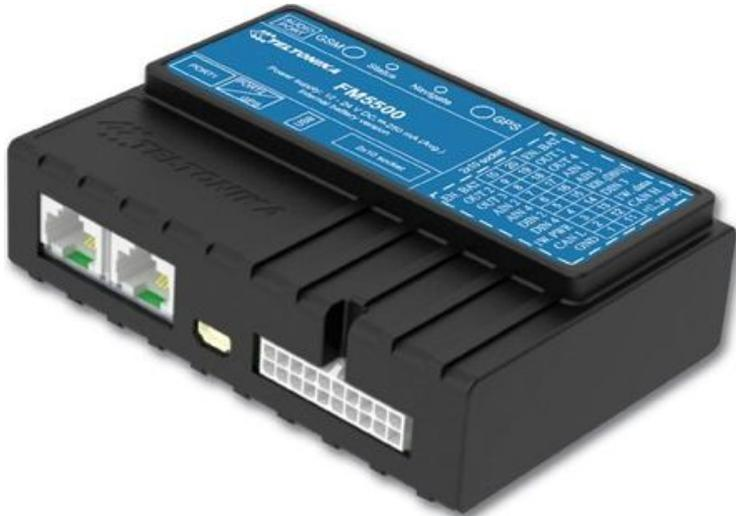
FM5500 - это уникальный терминал с двумя SIM картами встроенным модулем ГЛОНАСС/GPS для определения координат объекта и GSM модулем для передачи данных по GSM сети. Это устройство прекрасно подходит для контроля и отслеживания местонахождения удалённых объектов.
